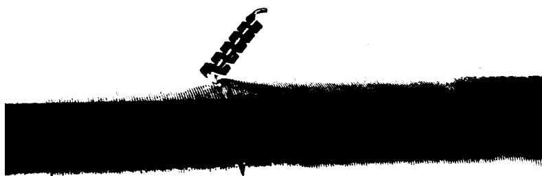
Obr. 10. Fotografia odchádzajúcej triesky Fig. 10 Turnings formed on the side of the tool face
