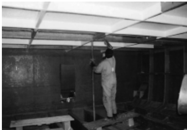
Obr. 6. Výstuhy hlavnej paluby Fig. 6. Main deck stiffeners
