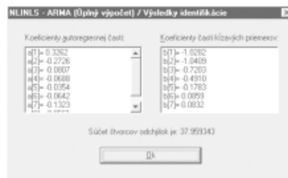
Obr. 5. Výsledky určenia rádu a koeficientov optimálneho modelu Fig. 5. Results of an optimal ARMA model determination
