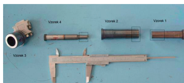
Fig. 2 Sample Nr. 1 - Cutting die
